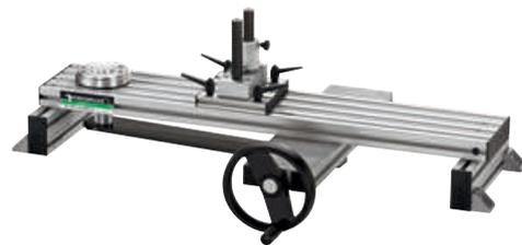
Die **mechanische Betätigungsvorrichtung** erlaubt eine schnelle, präzise Fixierung und Betätigung des Drehmomentschlüssels. Mit Hilfe der mechanischen Betätigungsvorrichtung ist unter anderem gewährleistet, dass gemäß DIN EN ISO 6789 für auslösende Drehmomentschlüssel ab 80 % des endgültigen Drehmomentzielwertes die Kraft langsam und stetig innerhalb der geforderten Zeit aufgebracht werden kann.
