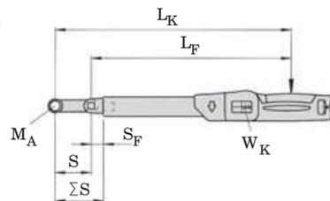
$$W_K = \frac{M_A \cdot L_F}{L_F - S_F + \Sigma S} = \frac{25 \text{ N} \cdot \text{m} \cdot 336 \text{ mm}}{336 \text{ mm} - 17,5 \text{ mm} + 17,5 \text{ mm} + 50,8 \text{ mm}} = 21,7 \text{ N} \cdot \text{m}$$
