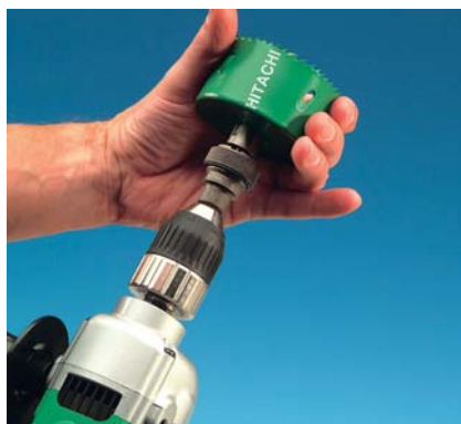
Lochsäge aufsetzen, eindrücken und um ein Viertel drehen:
