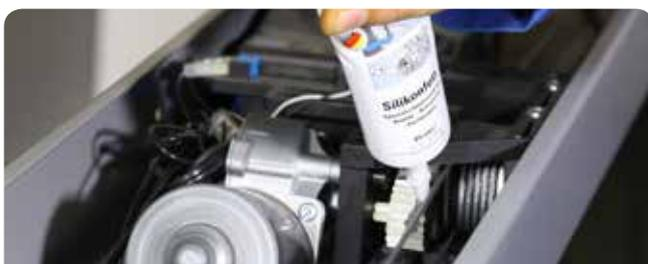
Fetten eines Kunststoffgetriebes
